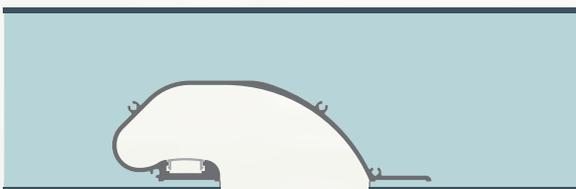
Sección horizontal del manillón oculto integrado
