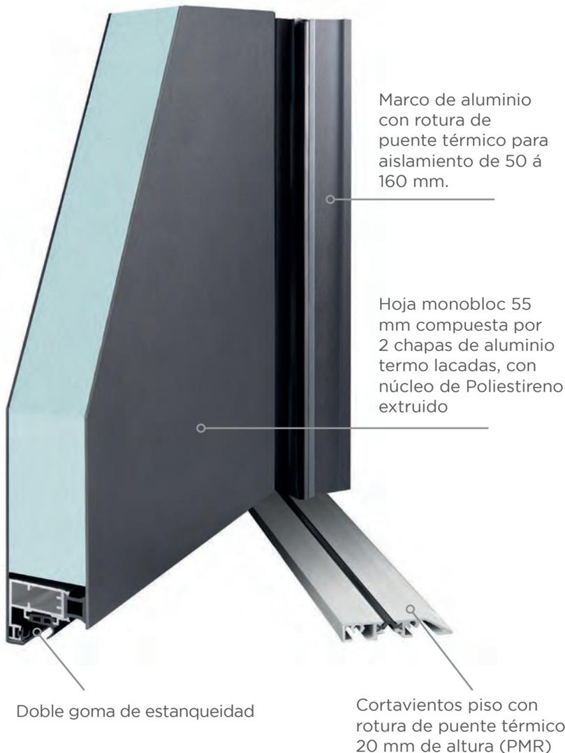
Marco de aluminio con rotura de puente térmico para aislamiento de 50 a 160 mm.
